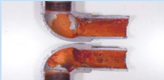
異金属接触腐食の例
