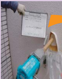
《コンクリートコア採取、強度試験》
