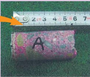
《コンクリートコア採取、強度試験》
