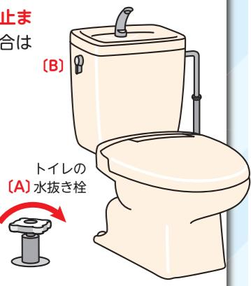
7 室内のすべての蛇口と空気入れ蛇口・水抜き用蛇口から水が完全に出なくなったことを確認してから、室内的すべての蛇口と空気入れ蛇口・水抜き用蛇口を閉める。
